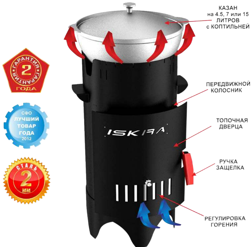
Рис. 2 Устройство печи ISKRA
